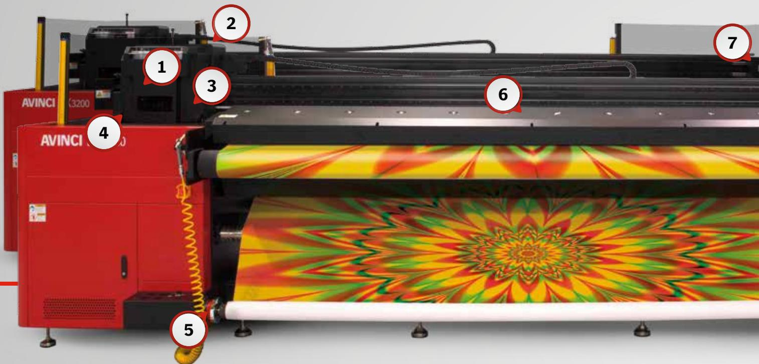
1. Kopf-Höhenverstellung, sodass der Avinci auf Textilien mit einer Dicke von bis zu 5 mm drucken kann.
